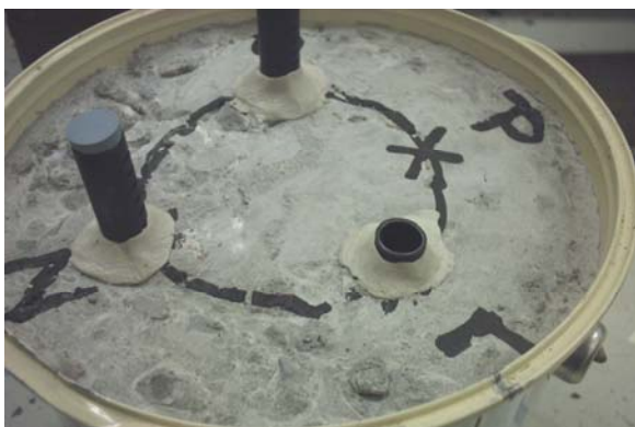
Figur 11. Mätrör för loggning av RF med Vaisala.
