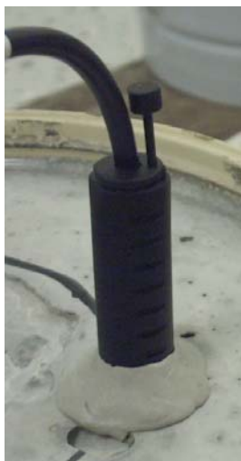
Figur 7. Mätör med monterad gummiplugg.
