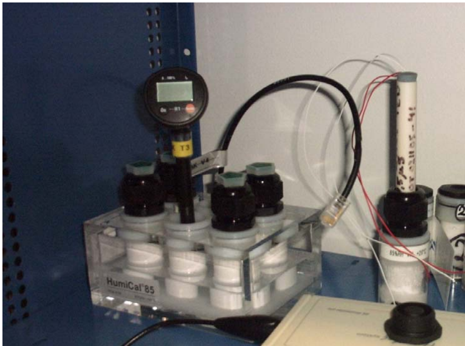
Figur 31. Kontroll av RF-givare över mättad saltlösning, 85% RF.
