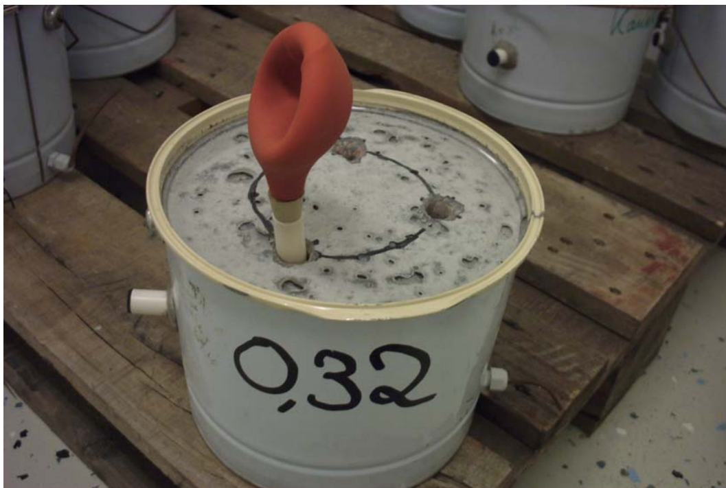
Figur 5. Täthetskontroll av mätrör.
